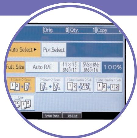
La pantalla simplificada muestra solamente un grupo selecto de las funciones más utilizadas para simplificar aún más la configuración de los trabajos por parte de los usuarios.
